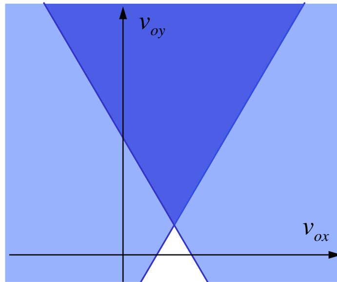
一般的に、物体は複数の点で接触するので、運動制約は速度と角速度に関する**連立不等式**となる
