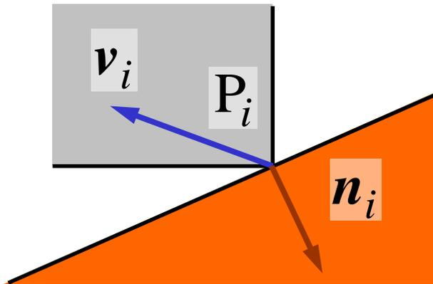
接触点 $P_i$ における固定物体の内向き法線ベクトルを $n_i$ とすると、運動物体の $P_i$ における速度 $v_i$ は以下の条件を満たさなくてはならない
