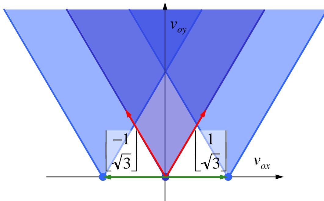
$$\begin{bmatrix} v_{ox} \\ v_{oy} \end{bmatrix} = \omega \begin{bmatrix} (2 - \sqrt{3})/\sqrt{3} \\ 0 \end{bmatrix} + c_1 \begin{bmatrix} 1 \\ \sqrt{3} \end{bmatrix} + c_2 \begin{bmatrix} -1 \\ \sqrt{3} \end{bmatrix}$$
