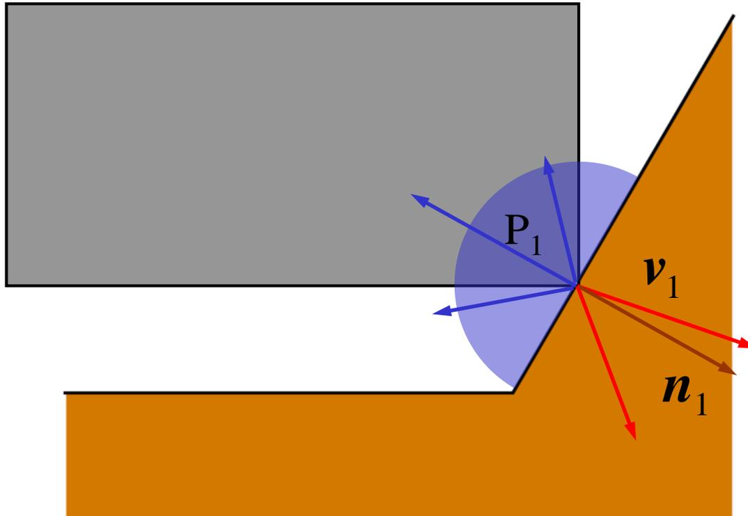
点 $P_1$ の速度 $v_1$ に関する制約:  $n_1 \cdot v_1 \leq 0$
