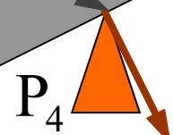
面-頂点接触の場合、運動物体の接触面外向き法線ベクトルを用いる
